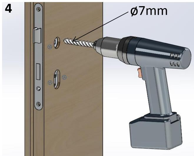
Tür auf beiden Türblattseiten an den markierten Stellen mit einem Ø7mm Bohrer bohren.
