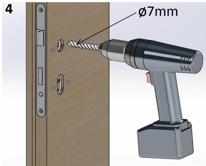
Tür auf beiden Türblattseiten an den markierten Stellen mit einem  $\varnothing 7\text{mm}$  Bohrer bohren.
